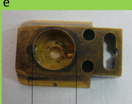
(d) MEB quanta 250 FEG équipé d'un module de cryopréparation PP3000T Quorum, (e) support de transfert adapté à la platine cryo du module de cryopréparation et (f) de la platine cryo du MEB.
