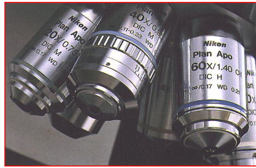
Figure 3 : tourelle d'objectifs et leurs caractéristiques.
