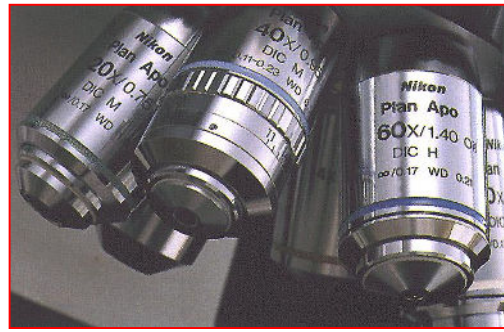
Figure 3 : tourelle d'objectifs et leurs caractéristiques.
